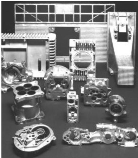
**FIGURA 2** Algunos ejemplos de piezas obtenidas por fundición
