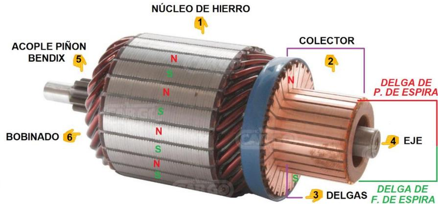
Imagen 4. Partes del rotor o inducido del motor de arranque.
