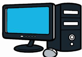
Una computadora es un dispositivo compuesto por una unidad de procesamiento de disco, que puede venir separada o unida a la pantalla, una pantalla. Tiene dispositivos de entrada (el teclado y el ratón) y los de salida son la pantalla y la impresora.
